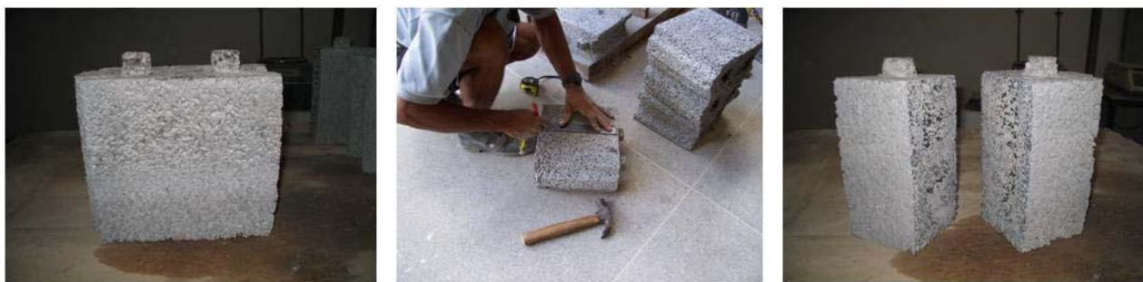
Figura 3.24 – Corte no bloco EVA originando dois meio blocos da família.
