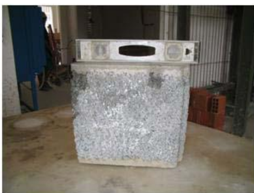
Figura 4.5 – Capeamento das faces do bloco EVA (esquerda) e ensaio de resistência à compressão (direita)
