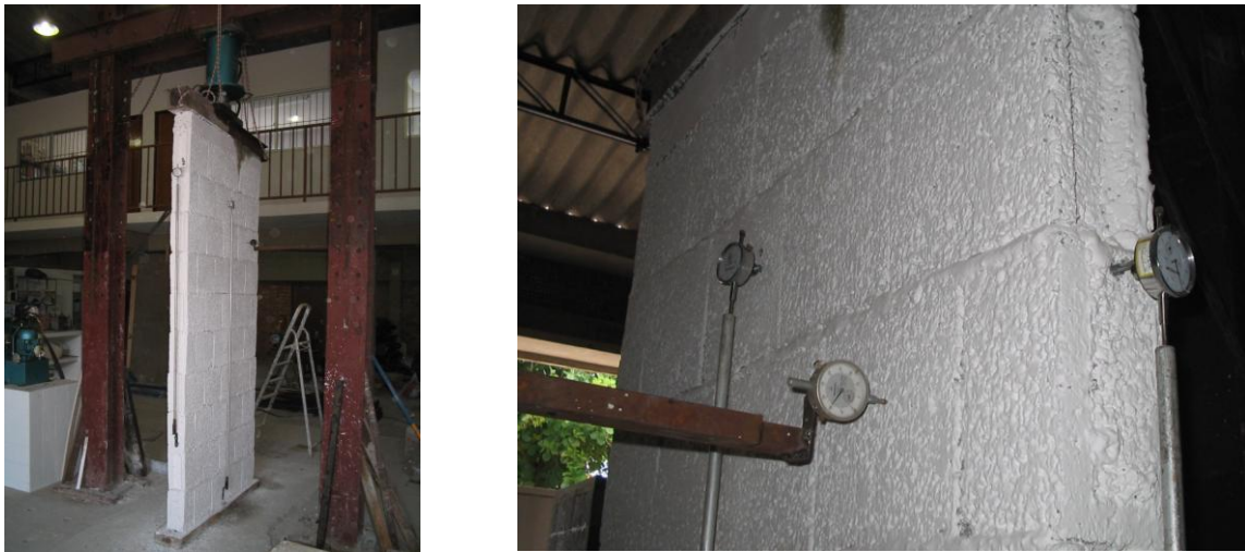
Figura 3.30 – Detalhe do painel pronto para ser ensaiado e do posicionamento dos defletômetros.
