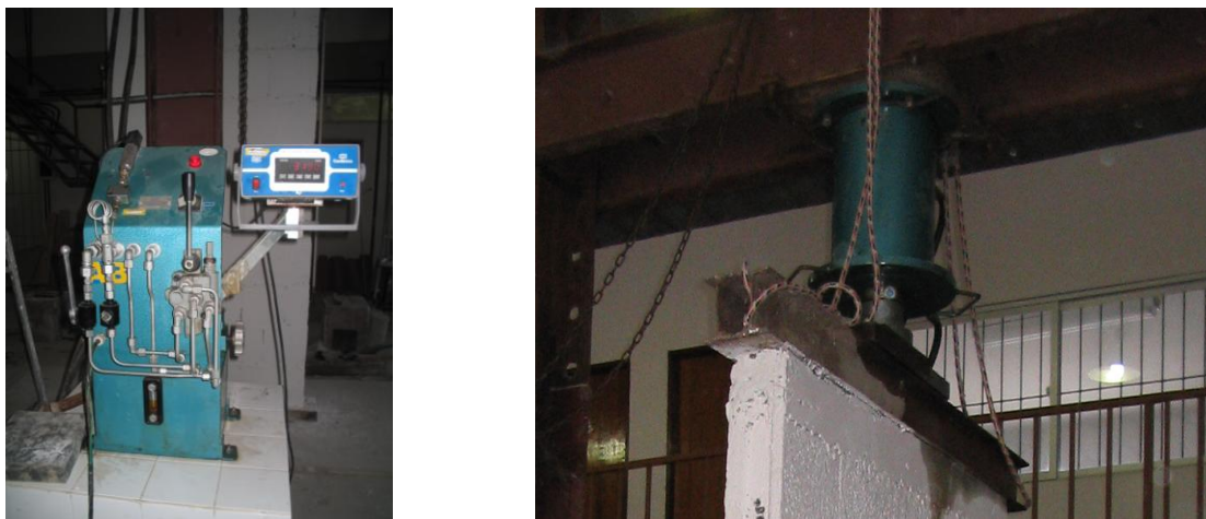
Figura 3.29 – Detalhe da prensa utilizada no ensaio de compressão dos painéis.
