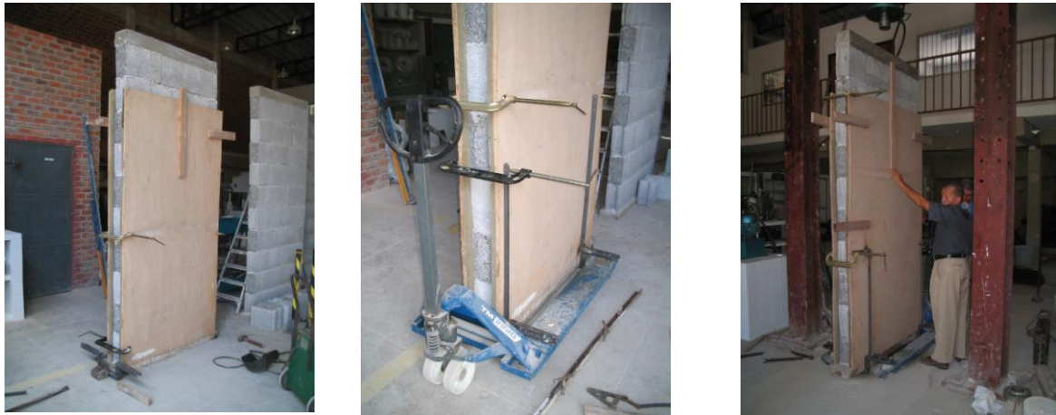
Figura 3.28 – Detalhe do procedimento de transporte dos painéis EVA ao local de ensaio.
