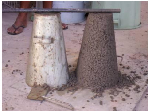
Figura 3.26. Ensaio de abatimento com o concreto com EVA.
