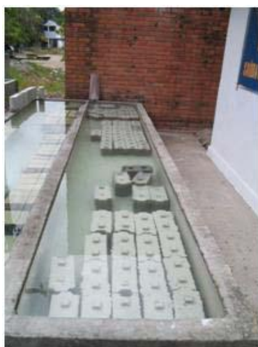
Figura 3.22 – Processo de cura dos blocos EVA imersos em tanque com água saturada com cal.
