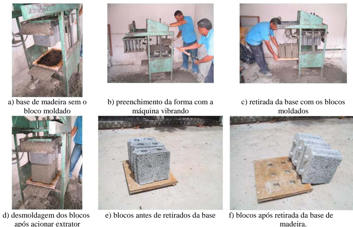
Figura 3.19 – Processo de moldagem e desforma dos blocos EVA com máquina vibro-prensa utilizada no LABEME/CT/UFPB.
