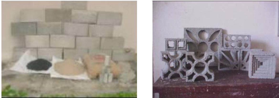
Figura 2.3 - Detalhe dos blocos de vedação produzidos a partir dos resíduos da indústria de calçados (EVA) e materiais utilizados na sua confecção (cimento, areia e EVA);
