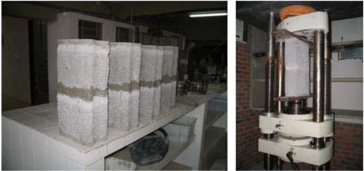
Figura 3.23 – Confeção dos prismas e ensaios de resistência à compressão dos mesmos
