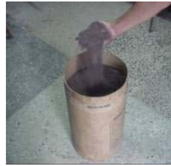
Figura 2.2- Detalhe do resíduo EVA em forma de aparas de sandálias pó FONTE: BEZERRA, 2002.
