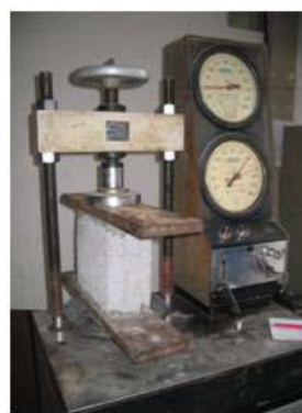
Figura 4.5 – Capeamento das faces do bloco EVA (esquerda) e ensaio de resistência à compressão (direita)
