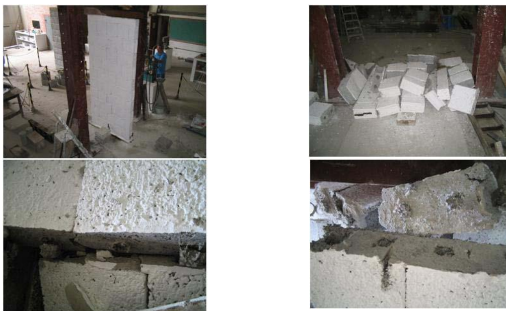
Figura 4.6 – Detalhes da primeira fissura e do final do ensaio após o colapso da parede com a sua desmontagem. Observa-se que vários blocos EVA se rompem apenas no encaixe, mas se mantêm inteiros nas outras partes.
