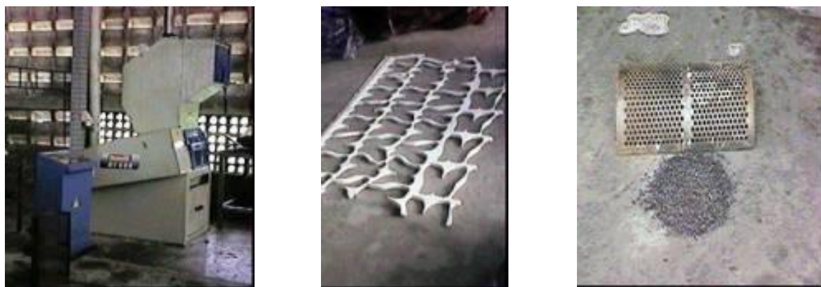
Figura 3.18– Detalhes de moinho triturador, retalhos das placas, peneira e agregado artificial de EVA.
