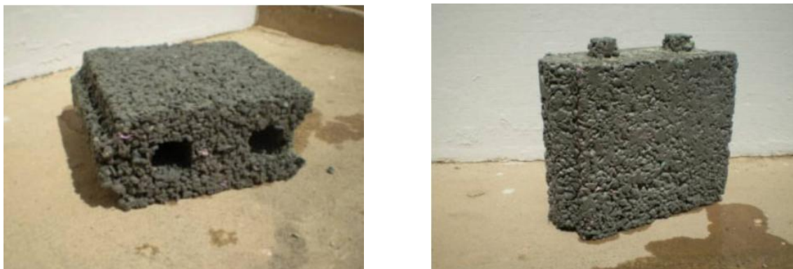
Figura 3.21 - Blocos EVA após cura inicial em câmara úmida
