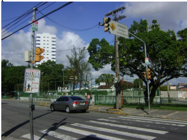
Figura 42: Rebaixamento de calçada sinalizado com faixa e semáforo, onde se observa desnível entre o fim do rebaixamento e o leito carroçável. Suporte do semáforo se encontra no meio da rampa. Fonte: Acervo pessoal.
