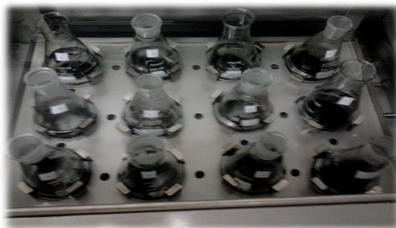
Figura 3.8 – Amostras dos carvões no banho-maria com agitação Dubnoff.
