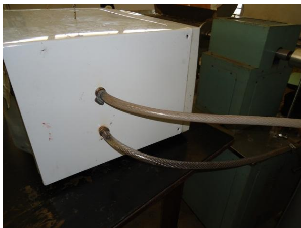
Figura 3.6 - Furos na lateral do micro-ondas.
