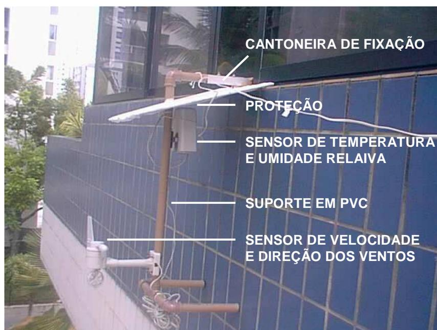
**Figura 25:** Fixação das estações meteorológicas nas fachadas.
