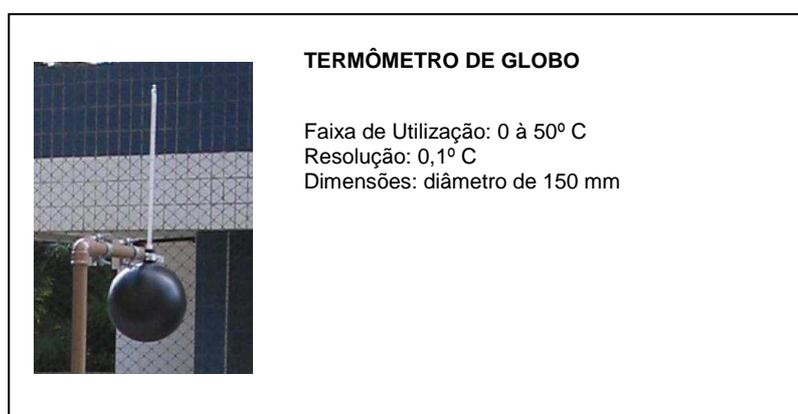
**Figura 22:** Especificações técnicas do termômetro de globo.
