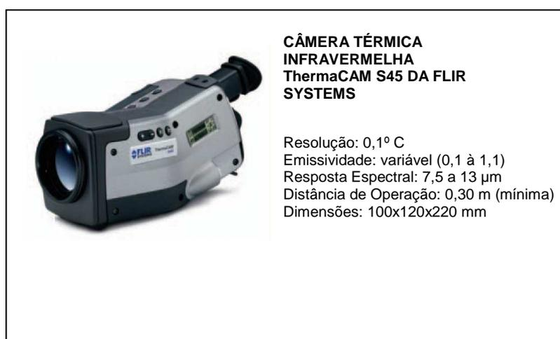
**Figura 24:** Especificações técnicas da câmera térmica Infravermelha ThermaCAM S45.
