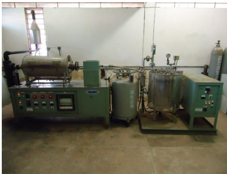
Figura 6: Forno-reator tubular de leito fixo com rampa de aquecimento digital em atmosfera de \text{N}_2 para pirólise, acoplado à caldeira elétrica da marca CHINO Fonte: Própria
