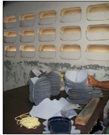
Figura 19 – Moldes dos Calçados Cortados
