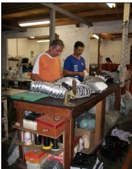
Figura 20 – Junção e Colagem da Borracha no Sintético
