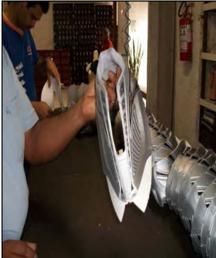
Figura 22 – Colagem do Forro
