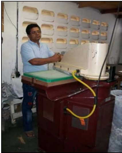
Figura 18 – Corte dos Moldes
