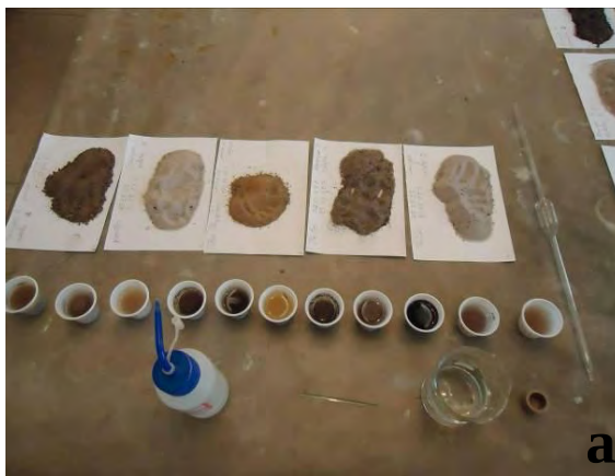
Foto 5.5a – amostras de solo com água destilada para medir o pH (Foto: GILVONETE FREITAS, 2011). Foto 5.5b – Eletrodos utilizados na leitura do pH (Foto: GILVONETE FREITAS, 2011).
