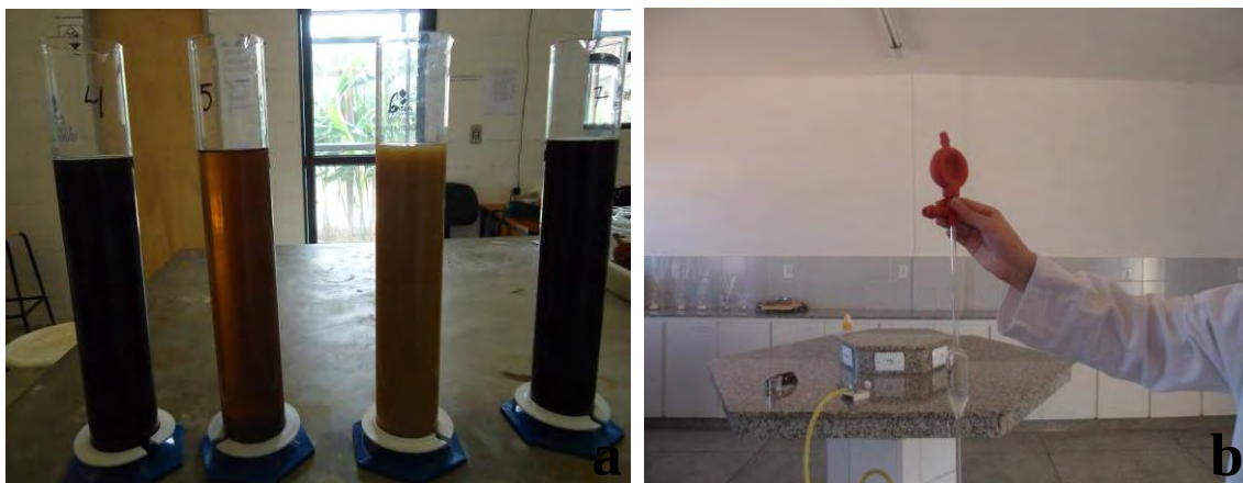
Foto 5.2a – Proveta de 1000 ml com o material que passou pela peneira e água destilada para realizar a sedimentação da fração argila (Foto: GILVONETE FREITAS, 2011). 5.2b – Pipeta utilizada para a coleta da suspensão, após o tempo de sedimentação, para realizar a análise granulométrica (Foto: GILVONETE FREITAS, 2011).
