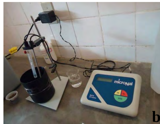
Foto 5.5a – amostras de solo com água destilada para medir o pH (Foto: GILVONETE FREITAS, 2011). Foto 5.5b – Eletrodos utilizados na leitura do pH (Foto: GILVONETE FREITAS, 2011).
