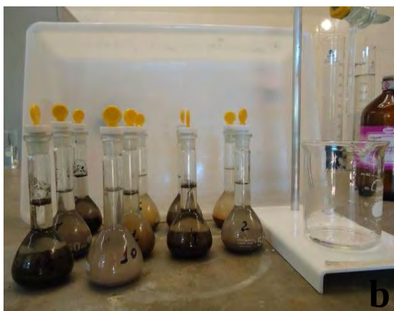
Foto 5.4a – Balança de precisão utilizada para pesar amostras de solo para análise das densidades das partículas (Foto: GILVONETE FREITAS, 2011). Foto 5.4b – Balões aferidos com as amostras de solo e álcool etílico para se calcular as densidades das partículas (Foto: GILVONETE FREITAS, 2011).
