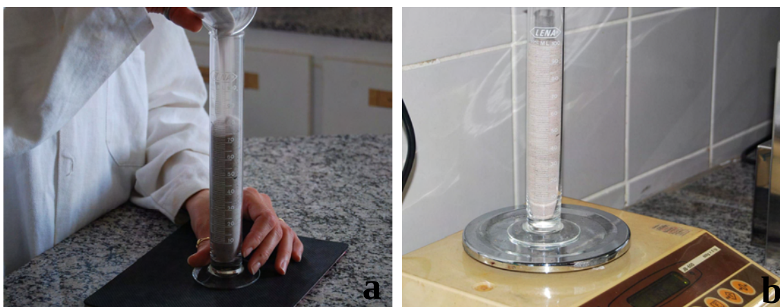
Foto 5.3a – Solo do becker sendo colocado na proveta para bater contra a manta de borracha (Foto: GILVONETE FREITAS, 2012). Foto 5.3b – Balança utilizada para pesar a proveta com o solo para análise da densidade do solo (Foto: GILVONETE FREITAS, 2012).
