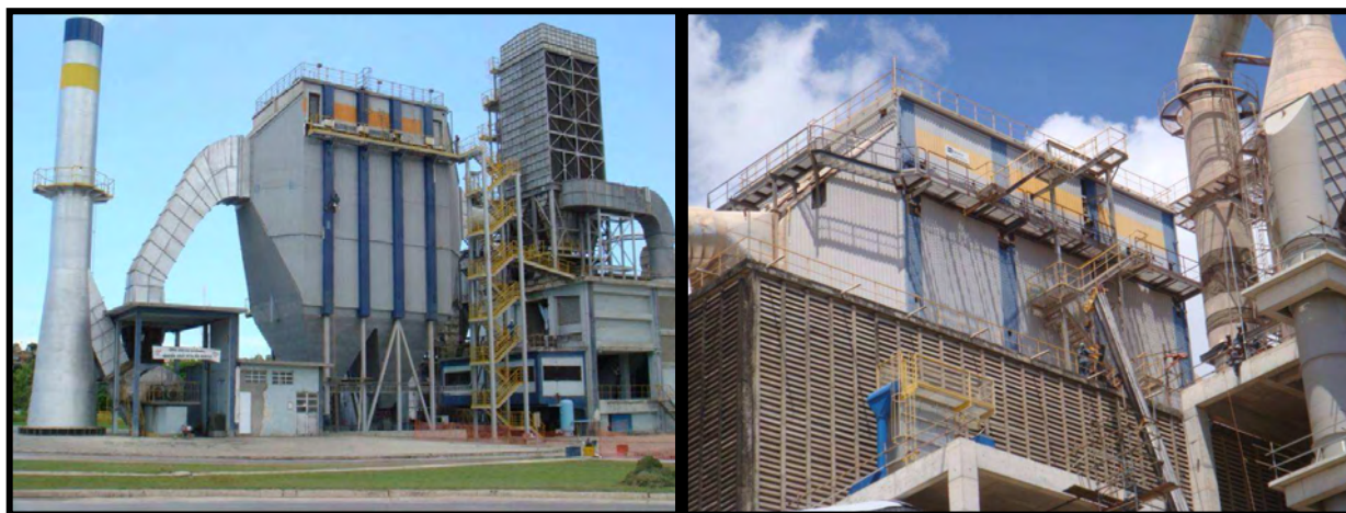
Figura 3.57 - Filtros de mangas instalados no resfriador, no forno e na moagem de cru (Foto: PRAD/2010).
