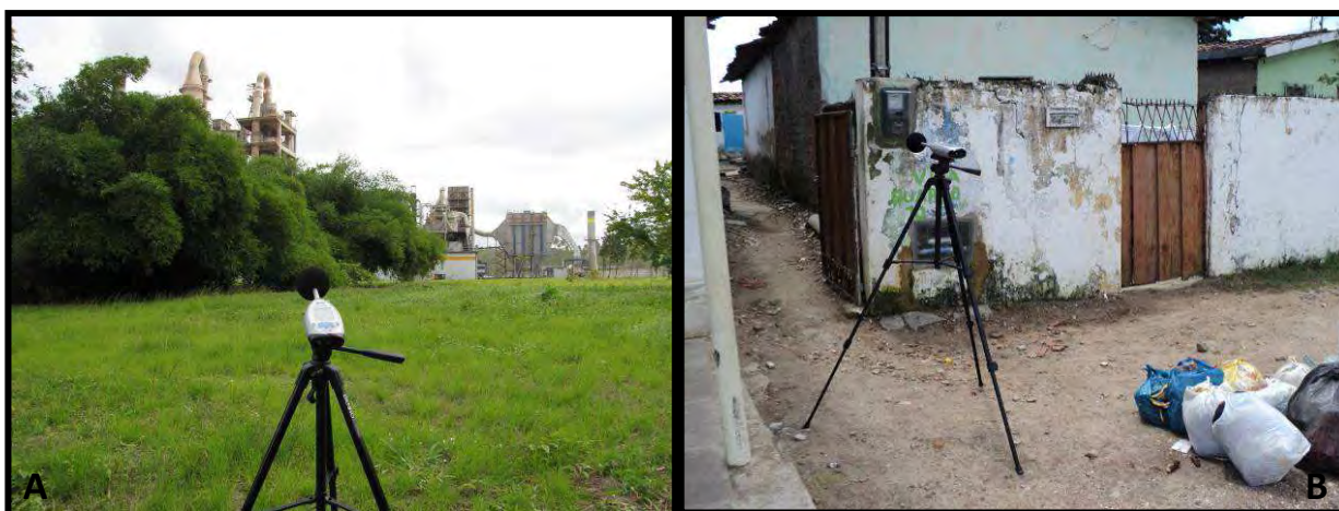
Figura 3.62 - Monitoramento de ruídos com uso de decibelímetro (A: área de menor densidade da barreira vegetal nas proximidades do Distrito Mecânico e B: próximo à escola Municipal Napoleão Laureano ao sul das áreas de lavra de argila) (Foto: PRAD/2010).
