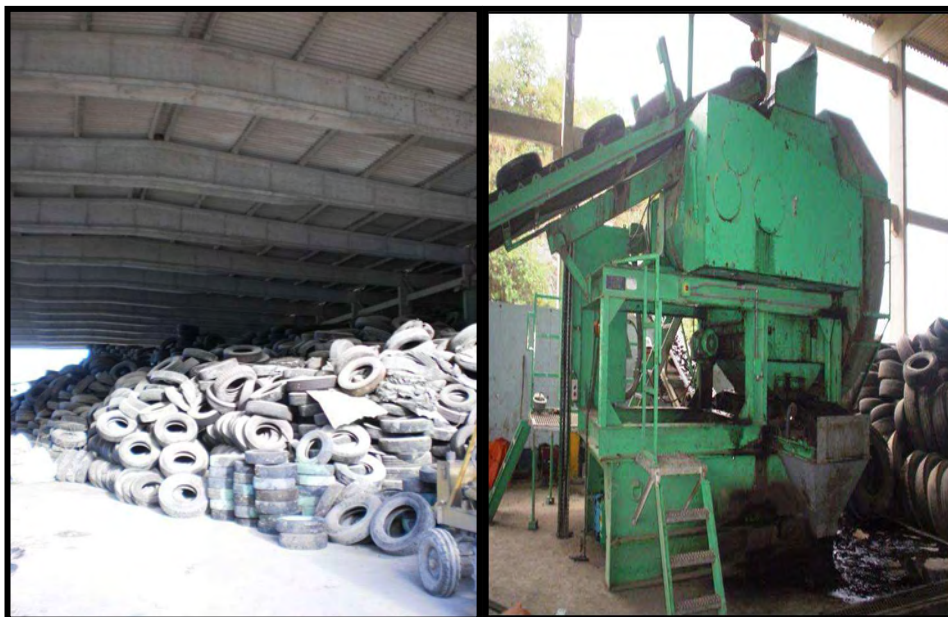
Figura 3.54 – Equipamento picador de pneus no local de estocagem dos pneus usados (Foto: PRAD/2010).
