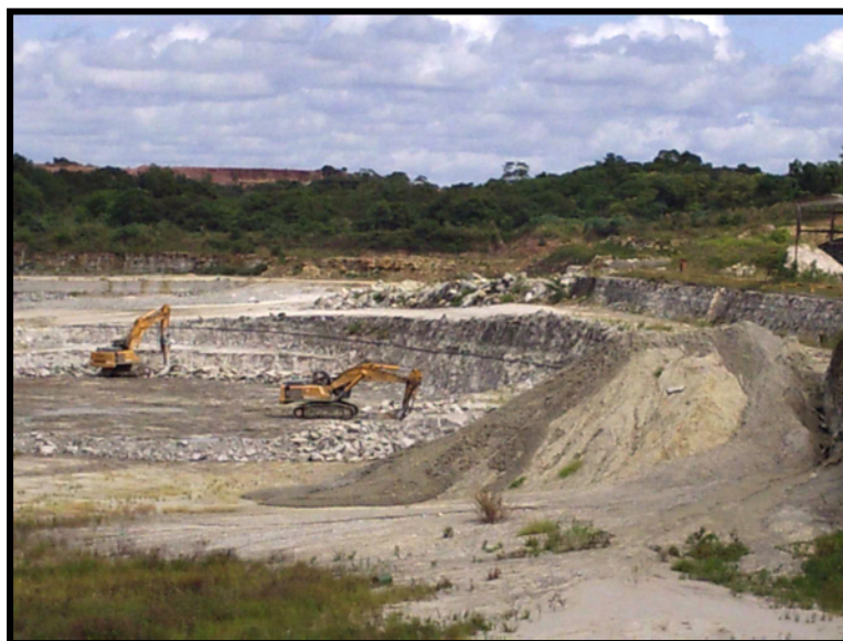
Figura 3.52 – Exploração de calcário com uso de rompedor hidráulico na Mina da Graça (Foto: Autor/2011).
