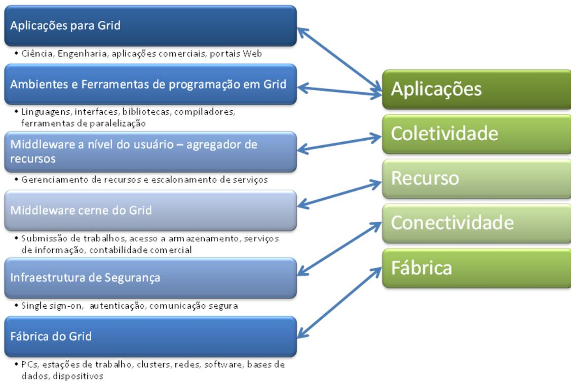
**Figura 3 – Arquitetura em camadas para a Computação em Grid (Chetty & Buyya, 2002) (ESQ) (Foster, et al., 2001) (DIR)**
