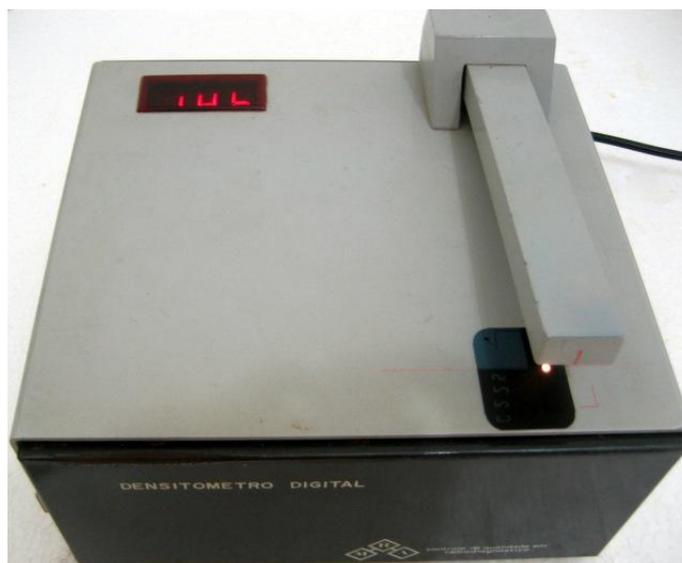
**Figura 4** - Fotodensitômetro MRA utilizado na pesquisa, pertencente ao DEN-UFPE
