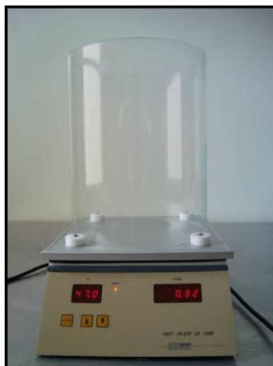
Figura 9 – Aparelho da placa quente.
