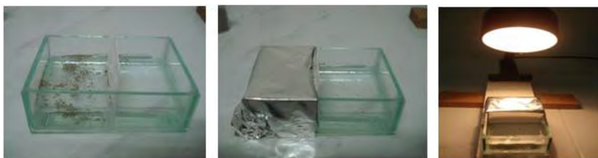
Figura 13 - Aspecto geral do experimento com Artemia salina . (A) Recipiente retangular com divisória contendo furos; (B) Parte coberta do sistema contendo os cistos; (C) Exposição à luz
