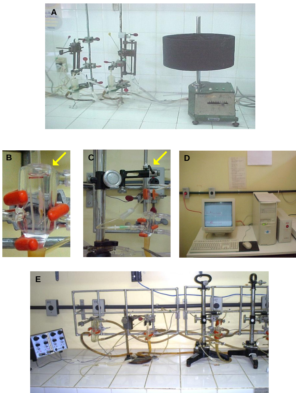
Figura 2 – Aparelhos utilizados para o registro de contrações: Aparato para registro das contrações isotônicas com cilindro esfumado de um quimógrafo (A), cuba de vidro (B), transdutor de força (C), microcomputador (D) e sistema de banho para órgão isolado (E).
