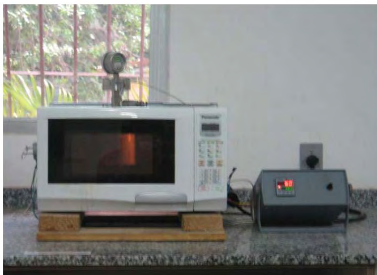
Figura 4.3 – Microondas hidrotermal adaptado a partir de um microondas doméstico e seu reator (OLIVEIRA, 2009).
