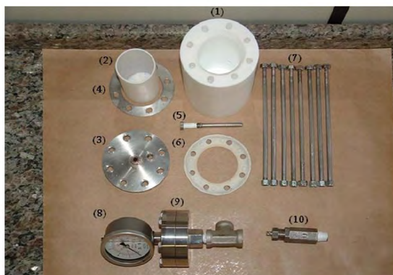
FIGURA 4.4 – Peças utilizadas no sistema hidrotermal em microondas. (1) reator de teflon, (2) copo de teflon, (3) tampa de aço inox, (4) protetor inferior de aço inox, (5) adaptador para o termopar, (6) vedador de teflon, (7) parafusos de encaixe, (8) e (9) manômetro e (10) válvula de segurança (OLIVEIRA, 2009).
