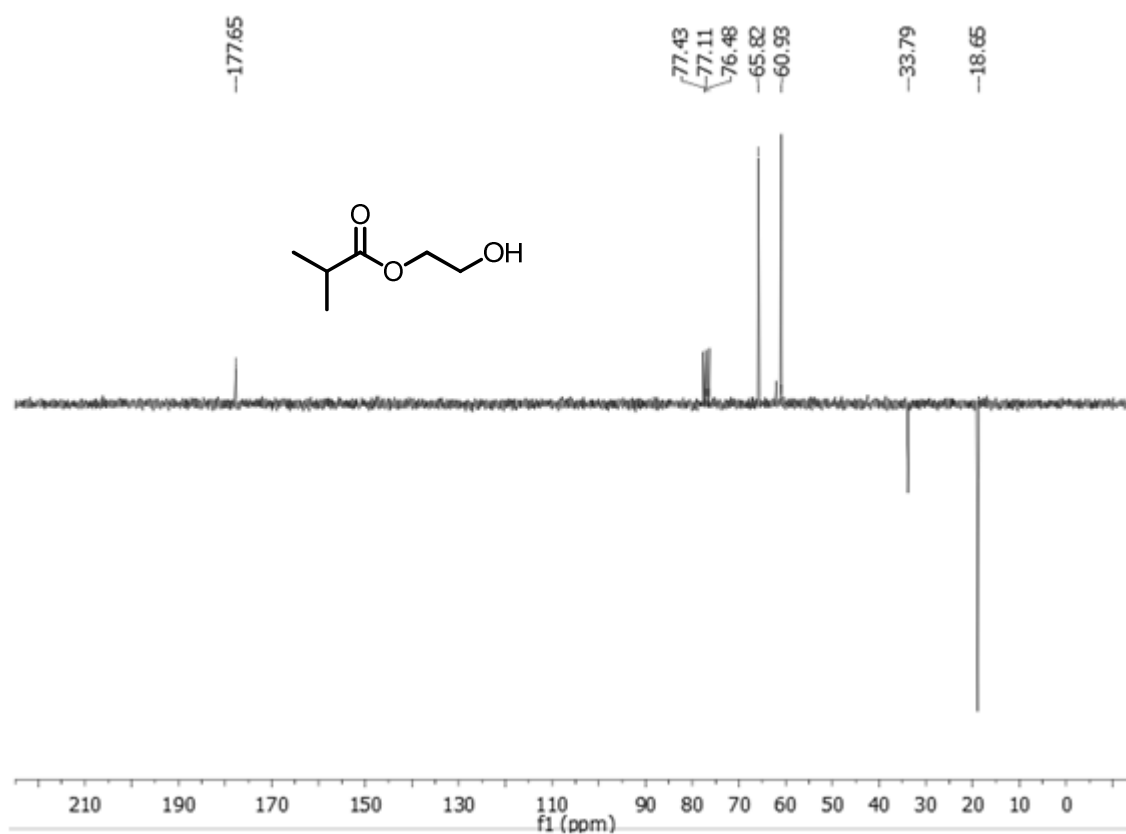
Espectro 10 Espectro ^{13}\text{C} da reação do etilenoglicol com anidrido produzindo 62
