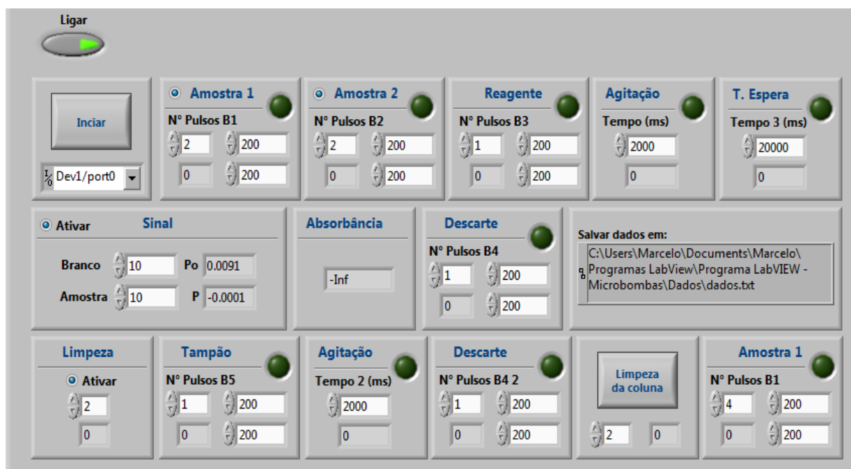
Figura 2.7 - Interface de controle automático do \mu FBA para análise de nitritos e nitrato em amostras de leite e laticínios
