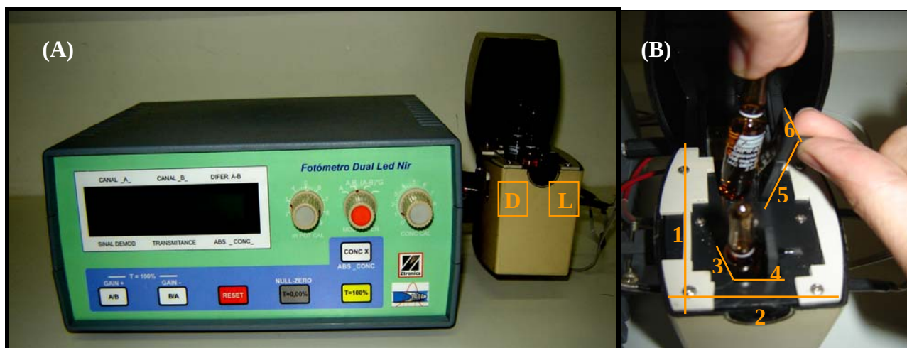
Figura 11 – Vista frontal (A), ilustrando o suporte para celas de medidas com as ampolas (B), na lateral do fotômetro. Onde: D indica a localização dos detectores, L indica a localização dos LEDs. Os números correspondem a dimensão do porta cubetas e do acessório para ampolas, onde: 1= 7,8 cm, 2= 5,8 cm; 3= 1,3 cm; 4= 1,3cm; 5= 4,2 cm e 6= 1,3 cm.
