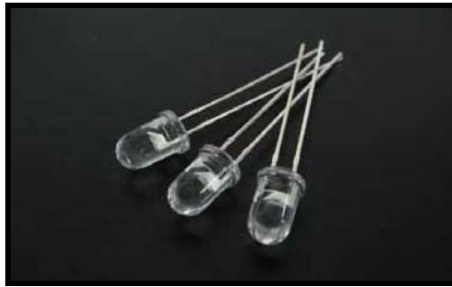
Figura 12. LEDs-NIR de InGaAsP utilizados no fotômetro.
