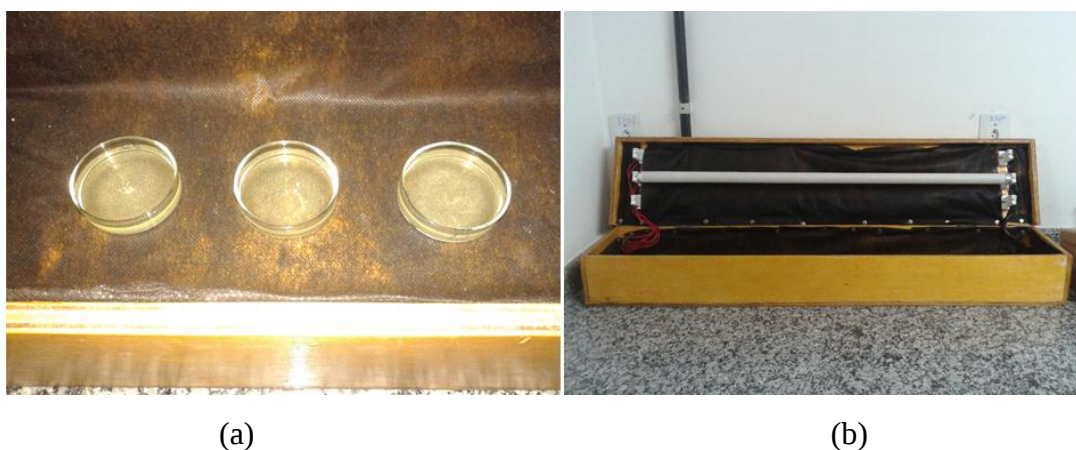
Figura 4.3. (a) Imagem das placas contendo o corante e catalisador, dentro do fotoreator; (b) Imagem do interior do fotoreator.
