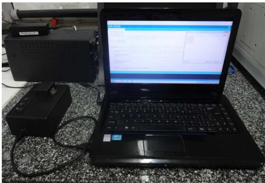
**Figura 2.11.** Sistema contendo o fotômetro proposto.
