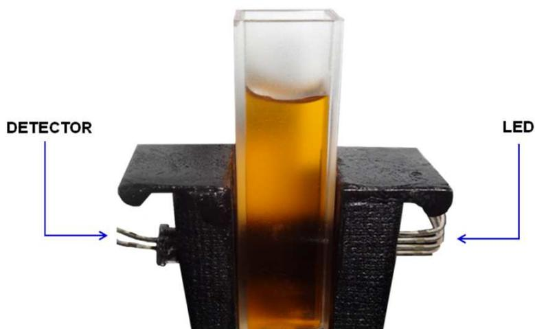
**Figura 2.6.** Suporte para cubeta usada no fotômetro de LED proposto.
