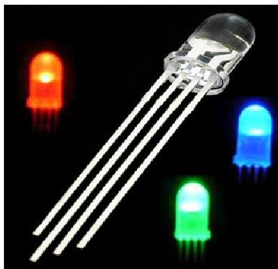
**Figura 2.2.** LEDs RGB utilizados no fotômetro.
