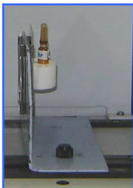
Figura 8 – Suporte das ampolas de medicamentos adaptado ao compartimento de medidas do espectrômetro NIR .
