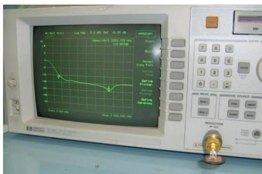
O analisador de redes é um equipamento que pode aferir e testar vários dispositivos (HP 8712C, 1988), entre os quais citam-se: diplexadores, filtros, acopladores, pontes, divisores, combinadores, circuladores, atenuadores, adaptadores, cargas, circuitos abertos, curtos, cargas, cabos, linhas de transmissão, guias de onda, ressoadores, dielétricos, antenas, chaves, multiplexadores, misturadores, multiplicadores, moduladores e osciladores.
