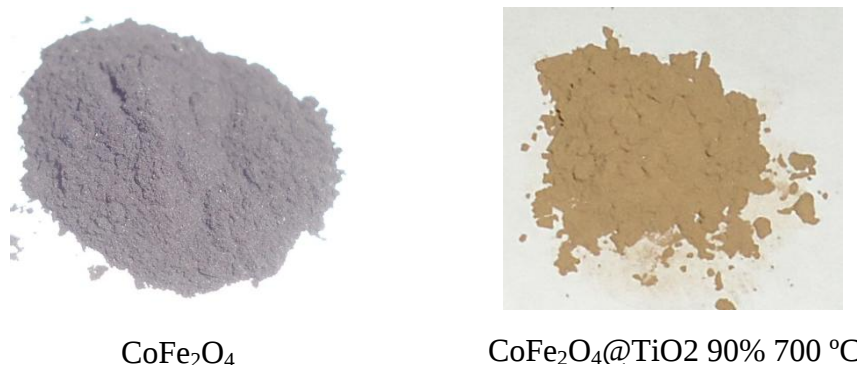
Figura 24. Variação da cor das amostras com a elevação da concentração de titânio no sistema core@shell .
