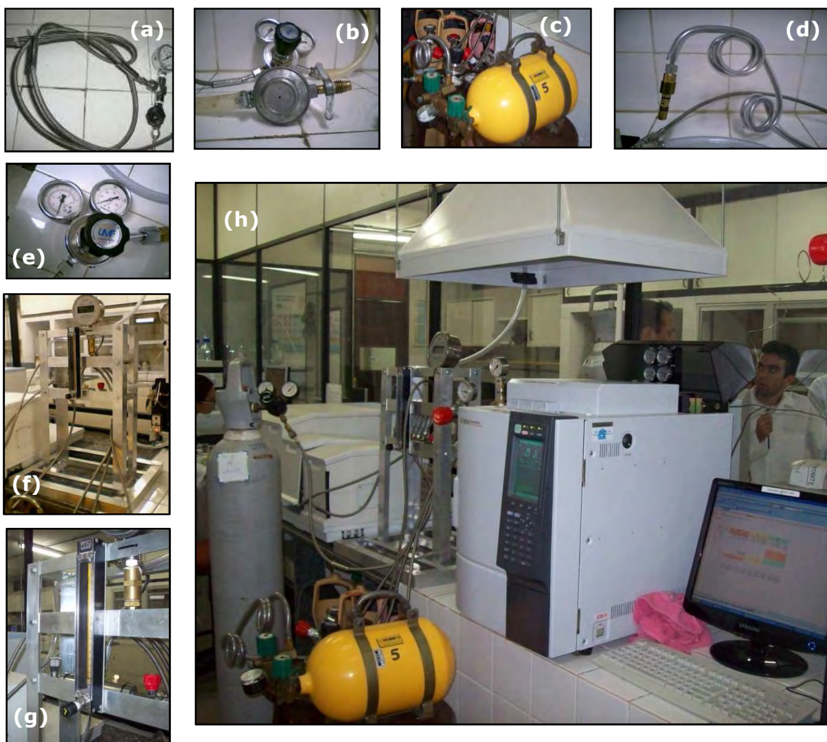
Figura 2.2. Fotografias dos principais equipamentos usados para manipulação de gases: (a) Mangueira flexível de alta pressão (Inox); (b) Adaptador para transferência de GLP; (c) Recipiente de amostragem de GNV; (d) Adaptador para transferência de GNV; (e) Regulador de pressão; (f) Sistema de injeção de amostra; (g) Fluxômetro; (h) Sistema de análise em linha com dois instrumentos (NIR e CG)
