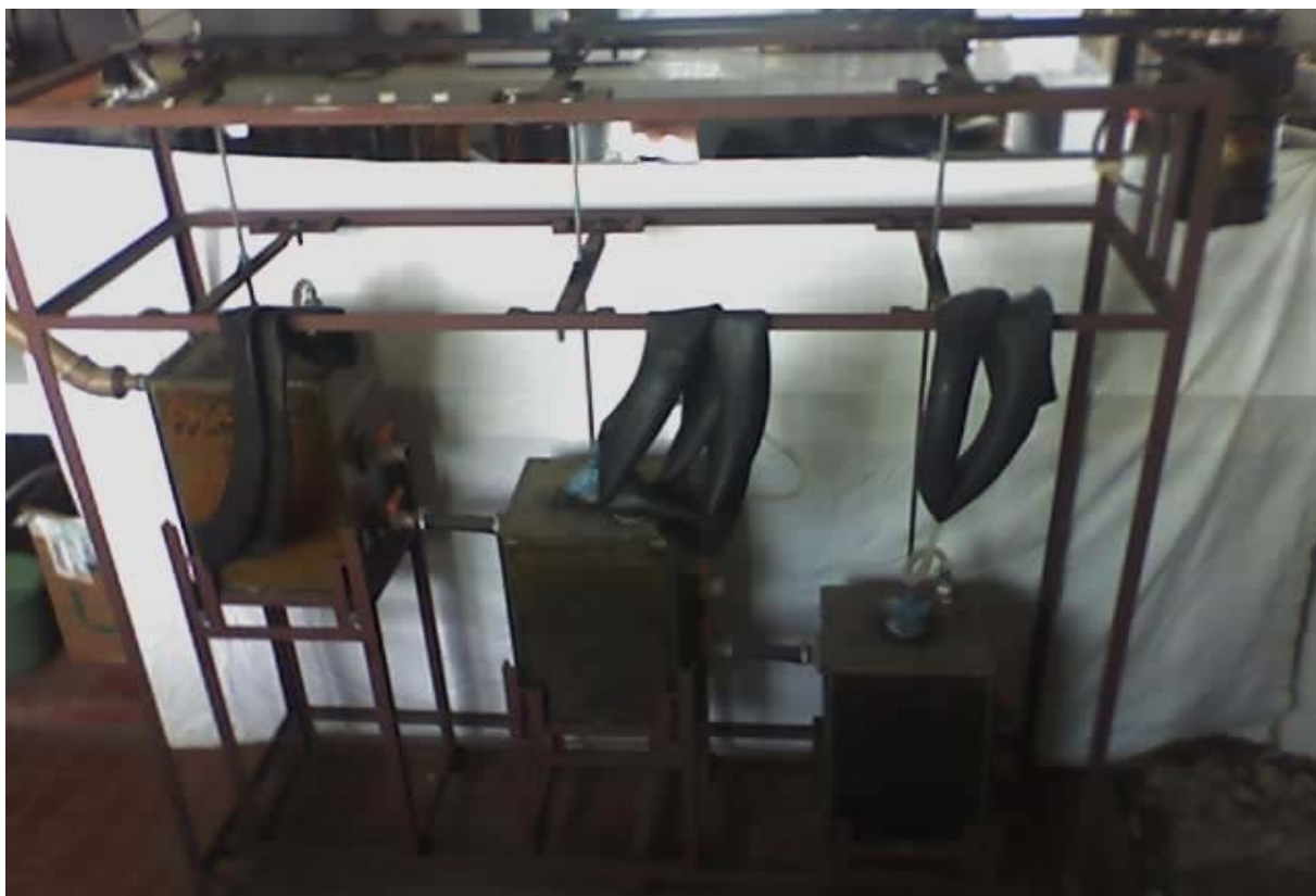
Figura 4.3 Fotografia do reator anaeróbio compartimentado utilizado para o desenvolvimento do trabalho.
