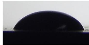
Figura 4. 28 - Gota formada entre o compósito contendo 20% de QC e o óleo.
