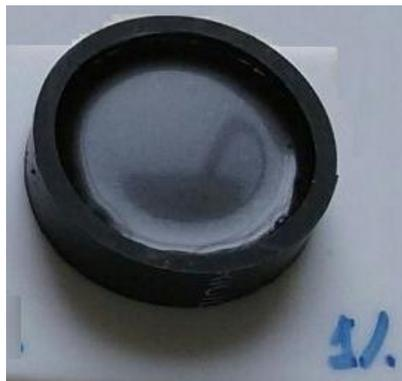
Figura 3. 3 - Compósito vazado no molde de PVC sobre uma placa de TEFLON.
