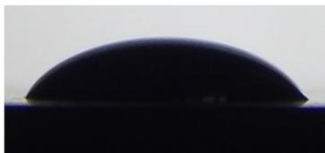
Figura 4. 29 - Gota formada entre o compósito contendo 30% de QC e o óleo.
