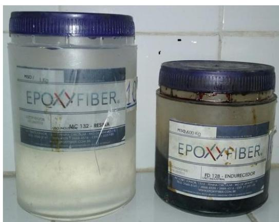
Figura 3. 2 - Resina Epoxy Fiber MC 132 e Endurecedor FD 128.
