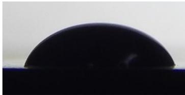
Figura 4. 27 - Gota formada entre o compósito contendo 10% de QC e o óleo.
