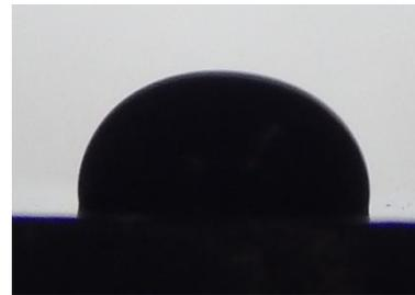
Figura 4. 30 - Gota formada entre o quasicristal puro e o óleo parafínico.
