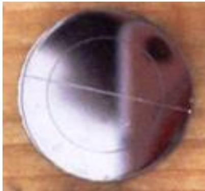
Figura 3. 5 - Amostra da liga quasicristalina AlCuFeB prensada e sinterizada (CAVALCANTE, 2009).
