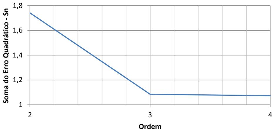
Figura 7.3 – Teste de detecção da ordem do sistema para  $n_b=2$  - Ramal 1
