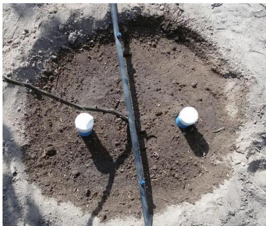
**Figura 4.** Estações de PVC utilizadas para as determinações de umidade e temperatura na profundidade de 15 cm e de 30 cm
