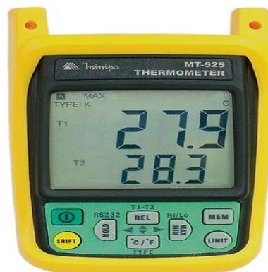
Figura 3.18 - Termômetro digital modelo MT - 525.
