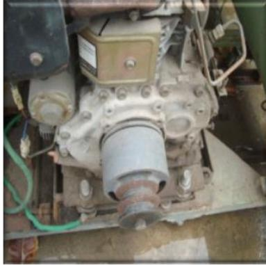
Figura AII. 5: Acoplamento da embreagem no eixo do motor.
