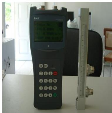
Figura 3.9 - Instrumento de Medição de Vazão Ultrassônico.
