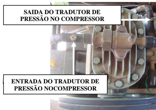
Figura 3.13 – Entrada e Saída do Tradutor de Pressão no Compressor.
