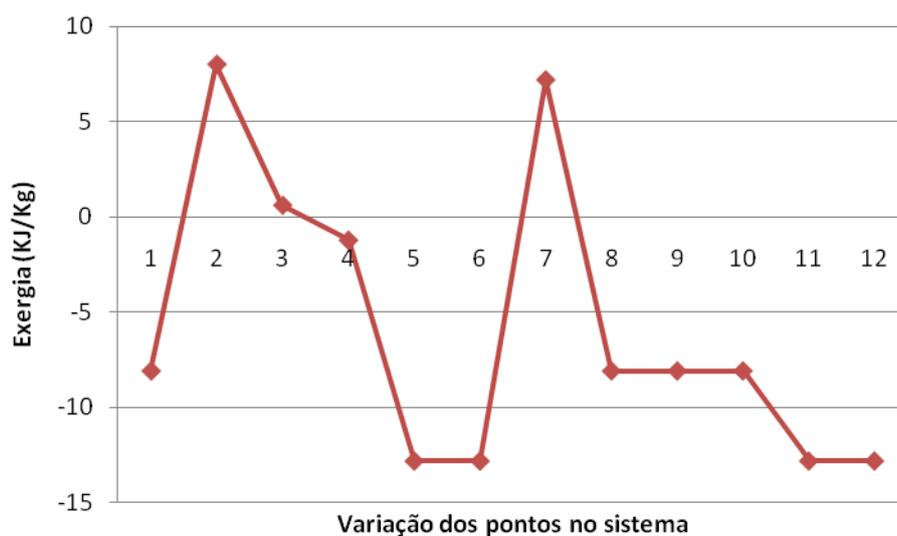
Figura 5.19 - Exergia em cada ponto do sistema para o compressor aberto utilizando diesel B20.
