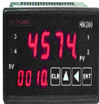
FIGURA 3.14 – INDICADOR E CONTROLADOR DE PRESSÃO
