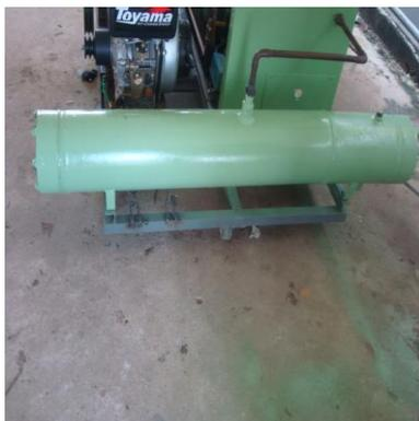
Figura 3.4 - Condensador Casco e Tubo
