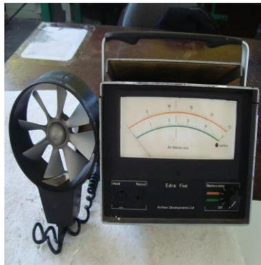
Figura 5.3 – Instrumento de Medição de Velocidade
