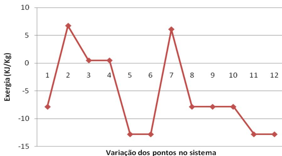
Figura 5.18 - Exergia em cada ponto do sistema para o compressor aberto utilizando diesel B5.
