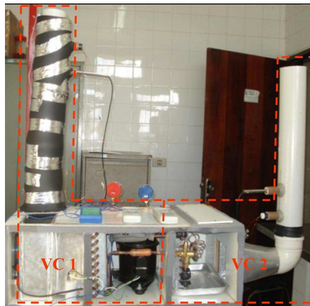
Figura 5.1: Bomba de calor em estudo
