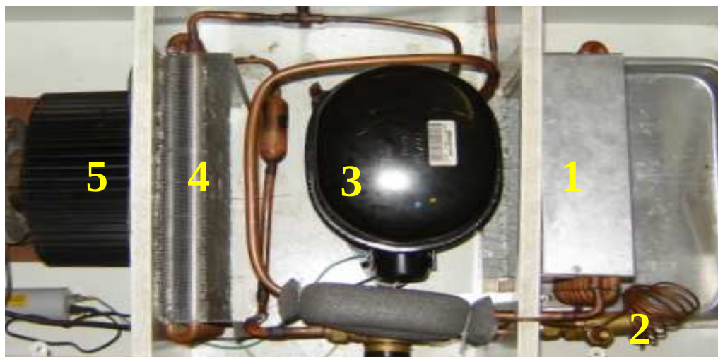
Figura 3.3: Bomba de calor (vista superior): (1) Evaporador; (2) Válvula de expansão; (3) Compressor; (4) Condensador e (5) Ventilador
