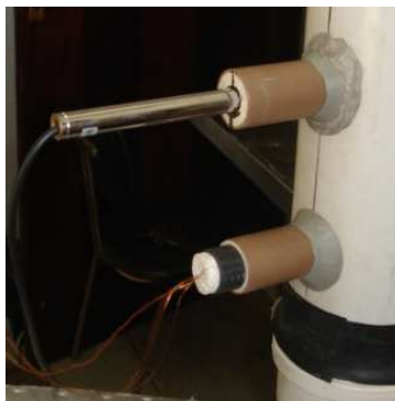
Figura 3.5: Sensores de temperatura do tipo PT 100 \Omega e anemômetro
