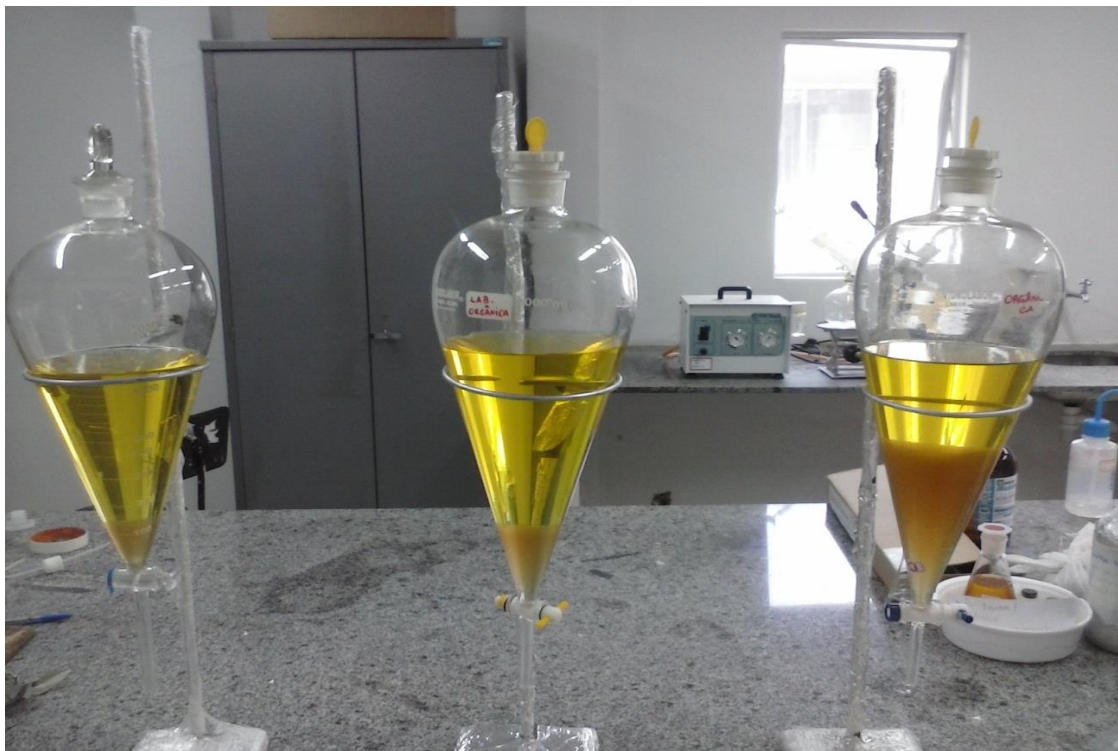
Figura 14 – Separação do biodiesel da glicerina
