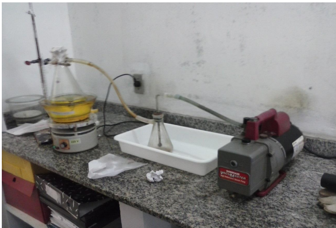
Figura 15 – Secagem a vácuo do biodiesel
