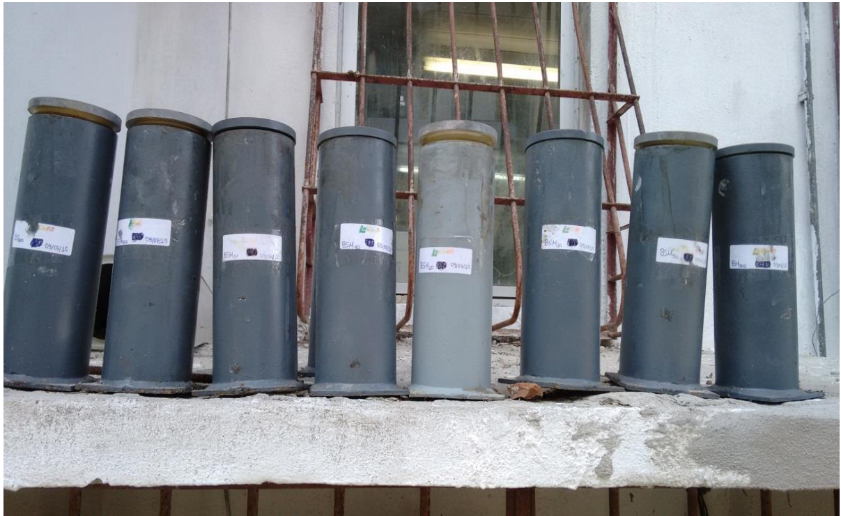
Figura 16 – Tanques de armazenamento dos biodieseis e blendas
