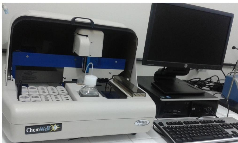
**Figura 10:** Equipamento de análise bioquímica Chem Well (CAVALCANTI, 2016).
